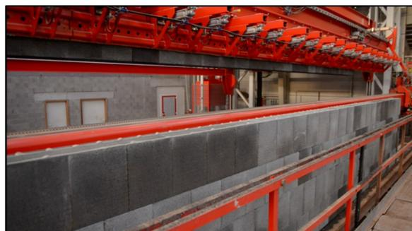
Production de murs jusqu'à 12m. Les dimensions précises et la planéité sont garanties.
